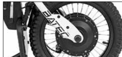
Die rechte Schutzkappe ist abnehmbar, für bequemen Austausch des Schlauchs oder Reifens.
