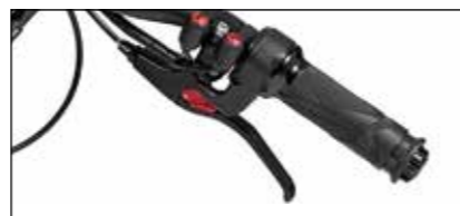
Mechanische Scheibenbremsen Avid BB5 und Aluminium-Bremsgriffe mit Feststellbremse.
