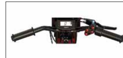
Optional kann für Menschen mit Hemiplegie eine Monolever-Bremse rechts oder links am Lenker angebracht werden.
