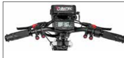
Aluminium-Lenker in Mattschwarz mit Faltmechanismus für den Transport.
